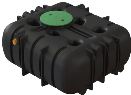
Robuster, flach gebauter Schlammabscheider mit großer Schlammspeicherkapazität. Ausgestattet mit 3 Kammern, die für eine besonders lange Absetzstrecke und optimale Klärleistung sorgen. Sehr hohe Schlammabscheidekapazität (0,06 g). Flexibles Design für unterschiedliche Grabtiefen und Voraussetzungen, Einlässe/Auslässe sowohl an der kurzen als auch an der langen Seite zu platzieren.
