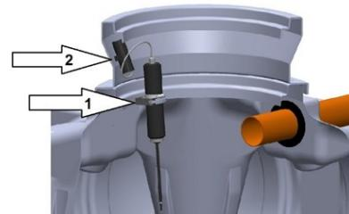
Bohren Sie ein 16 mm großes Loch für die Kabeldurchführung. Winkeln Sie das Loch ab! Bohren Sie mit einer Ahle o.ä. ein Loch in die Kabeldurchführung, durch das das Kabel gefädelt wird.
