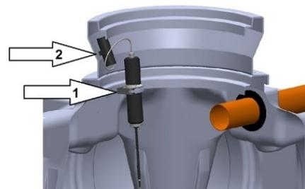
Boor een gat van 16 mm voor de kabeldoorvoer. Voorkom scherpe randen! Maak met een priem of soortgelijk gereedschap een gat in de kabeldoorvoer waar de kabel doorheen gaat.
