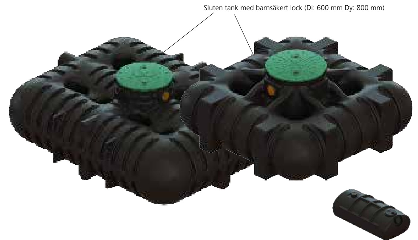
Sluten tank 2100 L för placering ovan mark
