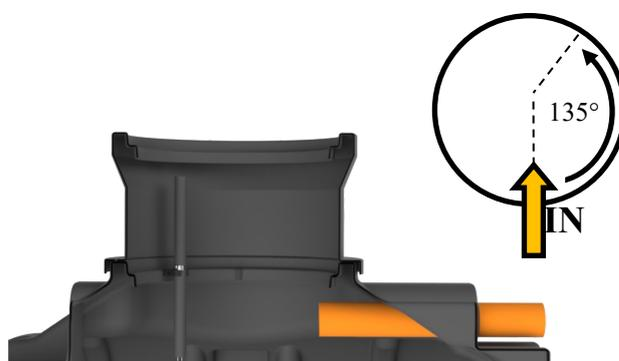
Borra ett hål (1) i förhöjningshalsen på lämpligt ställe. Grada hålet, montera gummigenomföringen, stick ett litet hål i den samma och dra igenom kabeln. Se till att skydda beln på utsidan.
