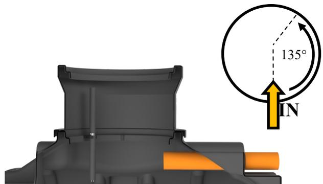
Boor op een geschikte plek in de verlengingsschacht een gat van 16 mm (1) in de verlengingsschacht. Ontbraam het gat, breng een rubber afsluiting aan, maakt hierin een klein gaatje en trek de kabel erdoor. Zorg ervoor dat de kabel aan de buitenkant beschermd is.
